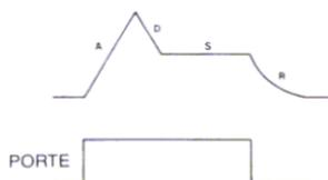
Noter que l'on peut maintenir le son au niveau de stabilisation intermédiaire aussi longtemps qu'on le désire. Le son ne commence à s'estomper qu'à la disparition de la porte. On peut utiliser cette enveloppe de base, avec des modifications mineures, pour les instruments à vent, les cuivres et les instruments à cordes.
