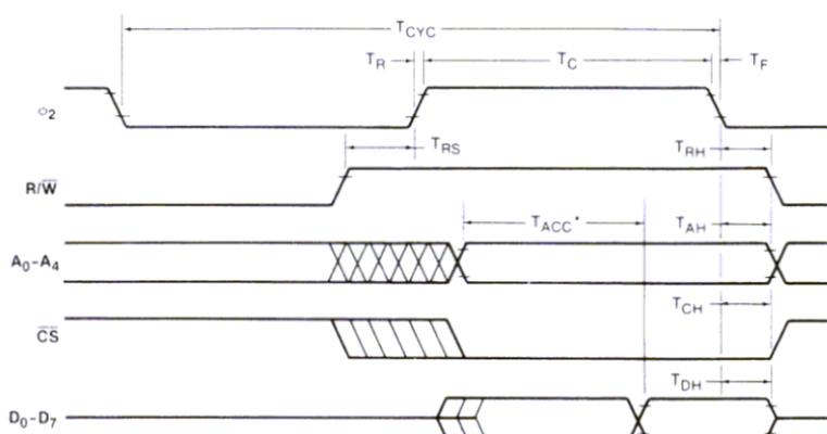
\* $T_{ACC}$  est mesurée après  $\phi_2$ ,  $\bar{CS}$  ou  $A_0-A_4$ , suivant l'action se produisant en dernier.
