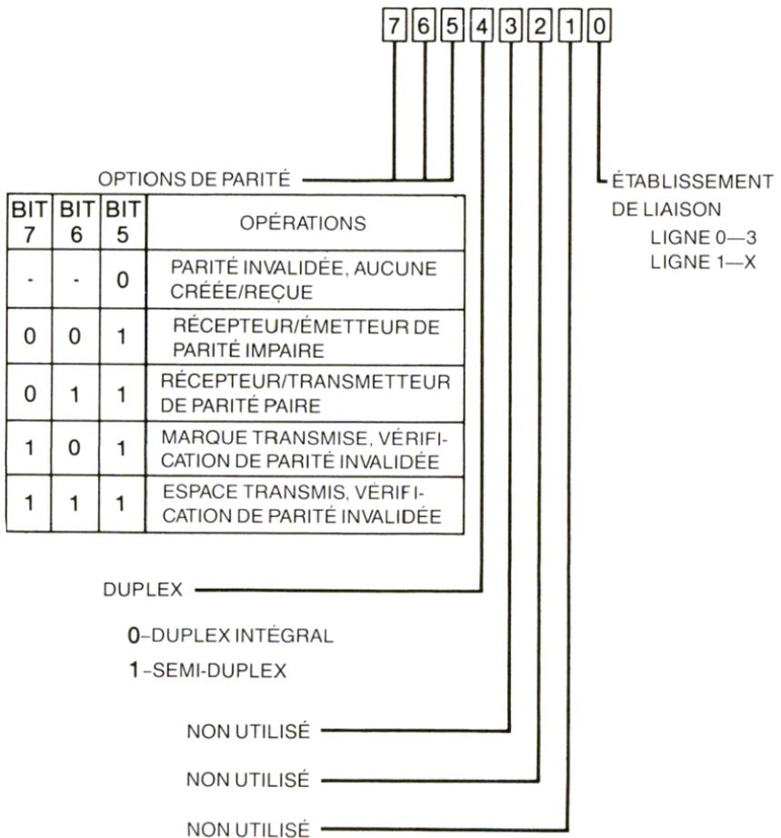
Figure 6-2. Topographie de registres de commande
