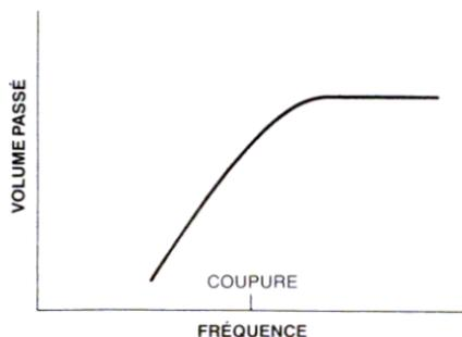
La microplaquette SID possède aussi un filtre *passé-bas*. Ce filtre laisse passer les fréquences au-dessous de la coupure et atténue les fréquences supérieures à cette coupure.
