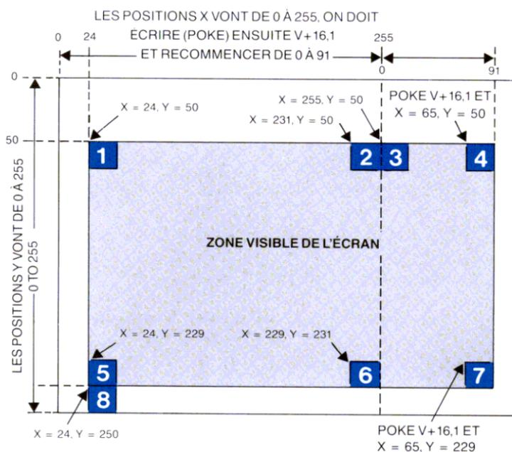
Figure 3-5. Détermination des positions X et Y de caractère graphique programmable.
