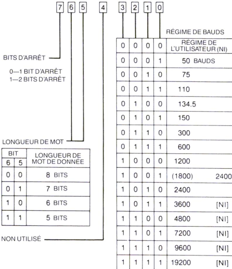
Figure 6-1. Topographie de registres de contrôle
