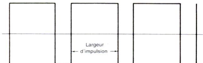
Cette onde est rectangulaire; on détermine la longueur du cycle d'impulsion en définissant la proportion de l'onde à l'état haut. Dans ce but, on utilise les registres 2 et 3 pour la voix 1. Le registre 2 correspond à l'octet bas de la largeur d'impulsion ( $L_{ij} = 0$  à 255). Le registre 3 correspond aux 4 bits ( $H_{ij} = 0$  à 15).
