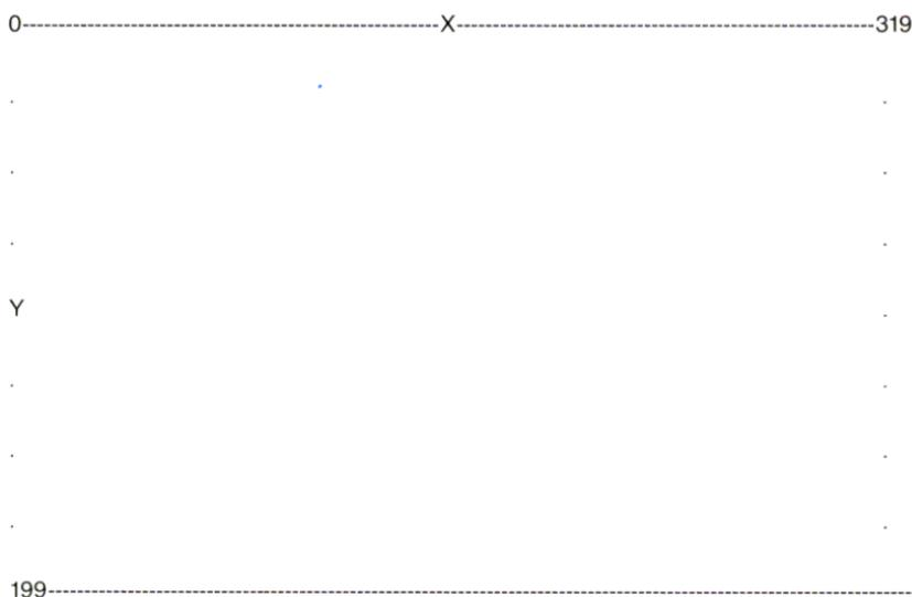
Chaque point possède des coordonnées X et Y. Ce format permet de fixer facilement tout point sur l'écran.
