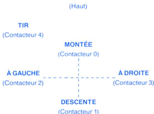
Ces contacteurs correspondent aux cinq bits inférieurs des données à la position 56320 ou 56321. Le bit est normalement fixé à 1 si l'on n'a pas choisi une direction ou si l'on n'a pas pressé le bouton de tir. Quand on appuie sur le bouton de tir, le bit 4 passe à 0. Pour lire la manette de commande à partir du BASIC, utiliser le sous-programme suivant:
