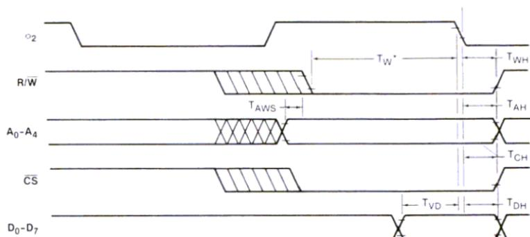
\*  $T_W$  est mesurée à partir de  $\phi_2$ , CS ou R/W, suivant l'action se produisant en dernier.
